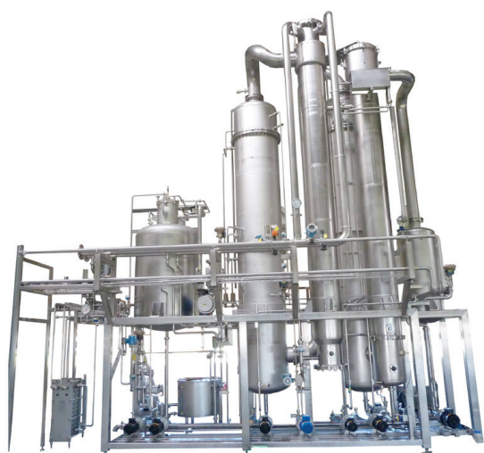
Uniwersalny zespół 30 hl do piwa, wina i cydru, zamontowany na ramie
